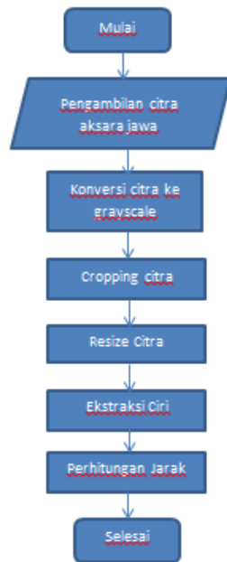
Gambar 2. Diagram alir untuk perancangan sistem
