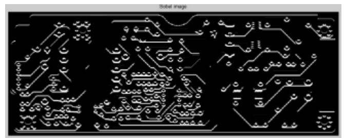
Gambar 11. Hasil citra deteksi Sobel
